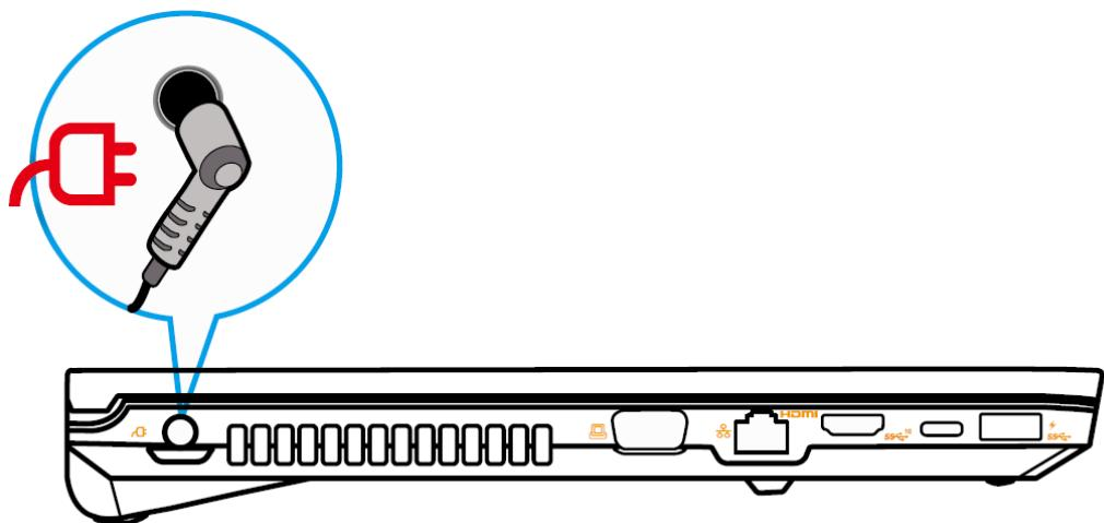
1. Conecte a saída DC de seu adaptador à entrada do conector DC
