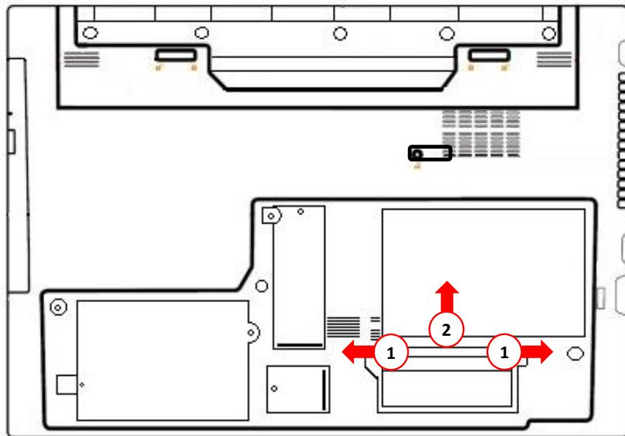
Por fim, destrave as memórias conforme indicado em 1, afastando as travas de dentro para fora e remova-as na direção indicada em 2.
