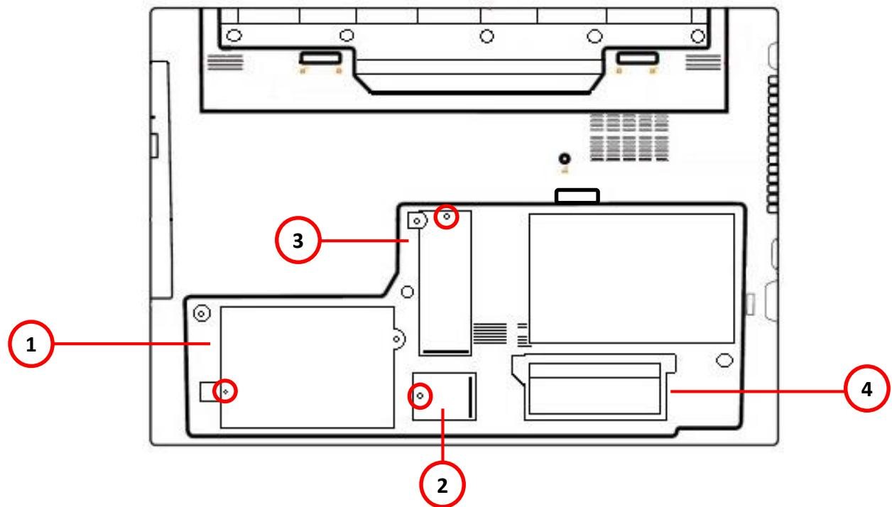
Ao abrir o compartimento, você terá acesso ao módulo de disco rígido, aos soquetes de memória RAM, ao módulo da WLAN e ao módulo do SSD.
